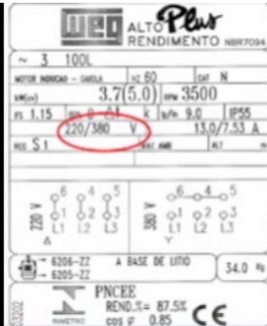
**A tensão de funcionamento na grande maioria dos motores elétricos são fornecidos com os terminais religáveis, de modo que possam funcionar ao menos em dois tipos de tensões. No caso da nossa placa 220 volts e 380 volts .**
