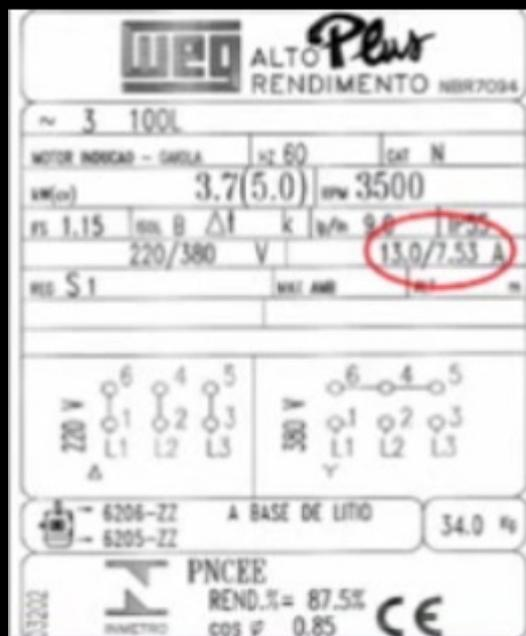
**A corrente nominal é lida na placa de IDENTIFICAÇÃO DO MOTOR, ou seja, aquela que o motor absorve da rede quando funcionando à potência nominal, sob tensão e frequência nominais.**
