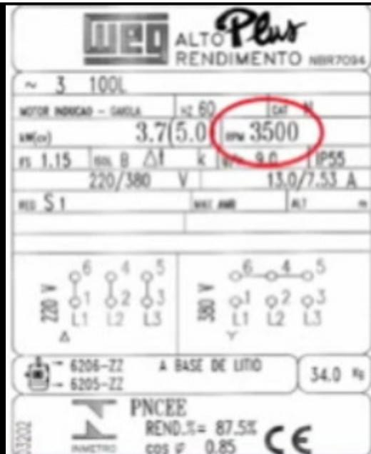
RPM ( ROTAÇÕES POR MINUTO ), **trata-se de um motor de 2 polos, um MOTOR DE ALTA rotação assíncrona .** **velocidade assíncrona é a rotação medida no EIXO DO MOTOR. Em síntese, é a verdadeira rotação do motor, descontado-se as perdas; daí o nome de motor assíncrono (em português assíncrono significa fora de sincronismo, no caso entre a velocidade do campo magnético e a do eixo do motor). O valor lido na placa dos motores, portanto valor nominal, é o valor da velocidade assíncrona.**
