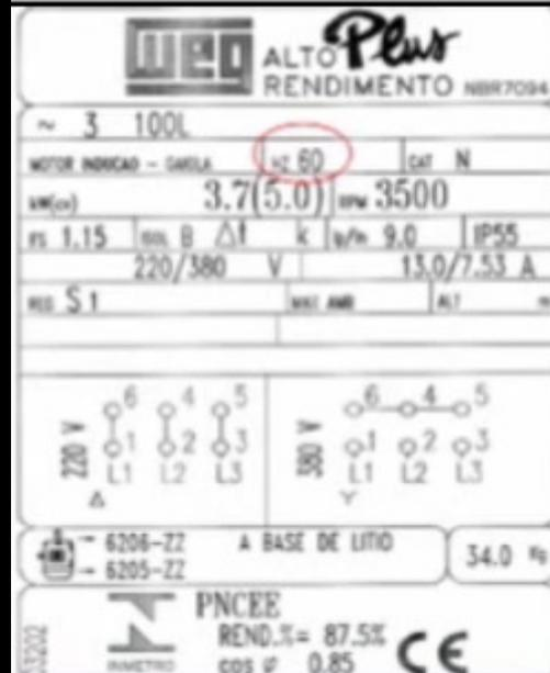
**Frequência nominal de trabalho do motor. quanto maior a frequência de um motor , maior vai ser a sua velocidade.(60 HZ)**
