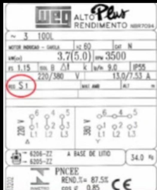
**Cada tipo de máquina exige uma condição de carga diferente do motor. Um ventilador ou uma bomba centrífuga, por exemplo, solicita carga contínua,**
