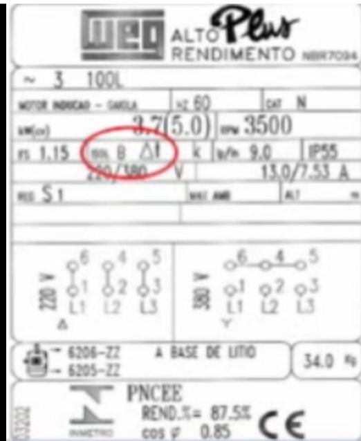
**É a determinação da temperatura máxima de trabalho, que o motor pode suportar continuamente sem ter prejuízos em sua vida útil.**
