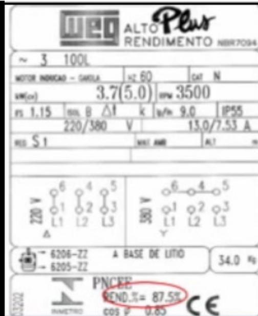
A energia elétrica absorvida da rede por um motor elétrico é transformada em energia mecânica disponível no eixo. A potência ativa fornecida pela rede não será cedida na totalidade como sendo potência mecânica no eixo do motor. A potência cedida sofre uma diminuição relativa as perdas que ocorrem no motor. O rendimento define a eficiência desta transformação sendo expresso por um número ( $<1$ ) ou em percentagem.
